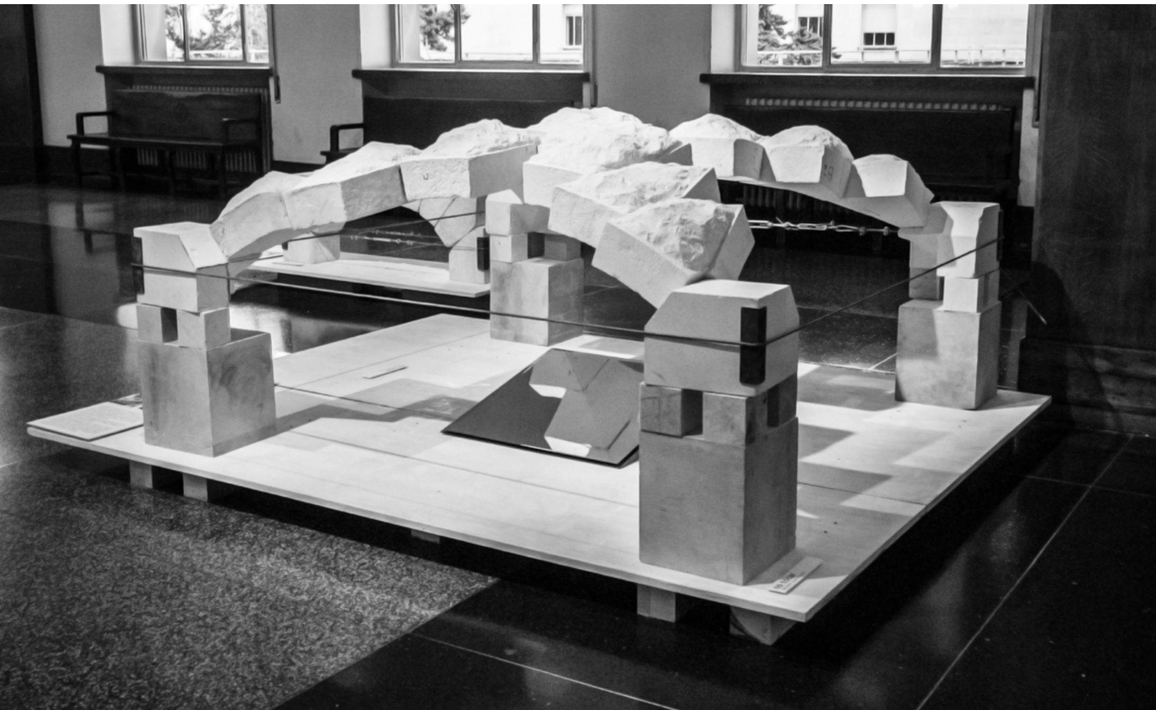
Bóveda de arista tallada por los procedimientos del tratado de Gelabert
