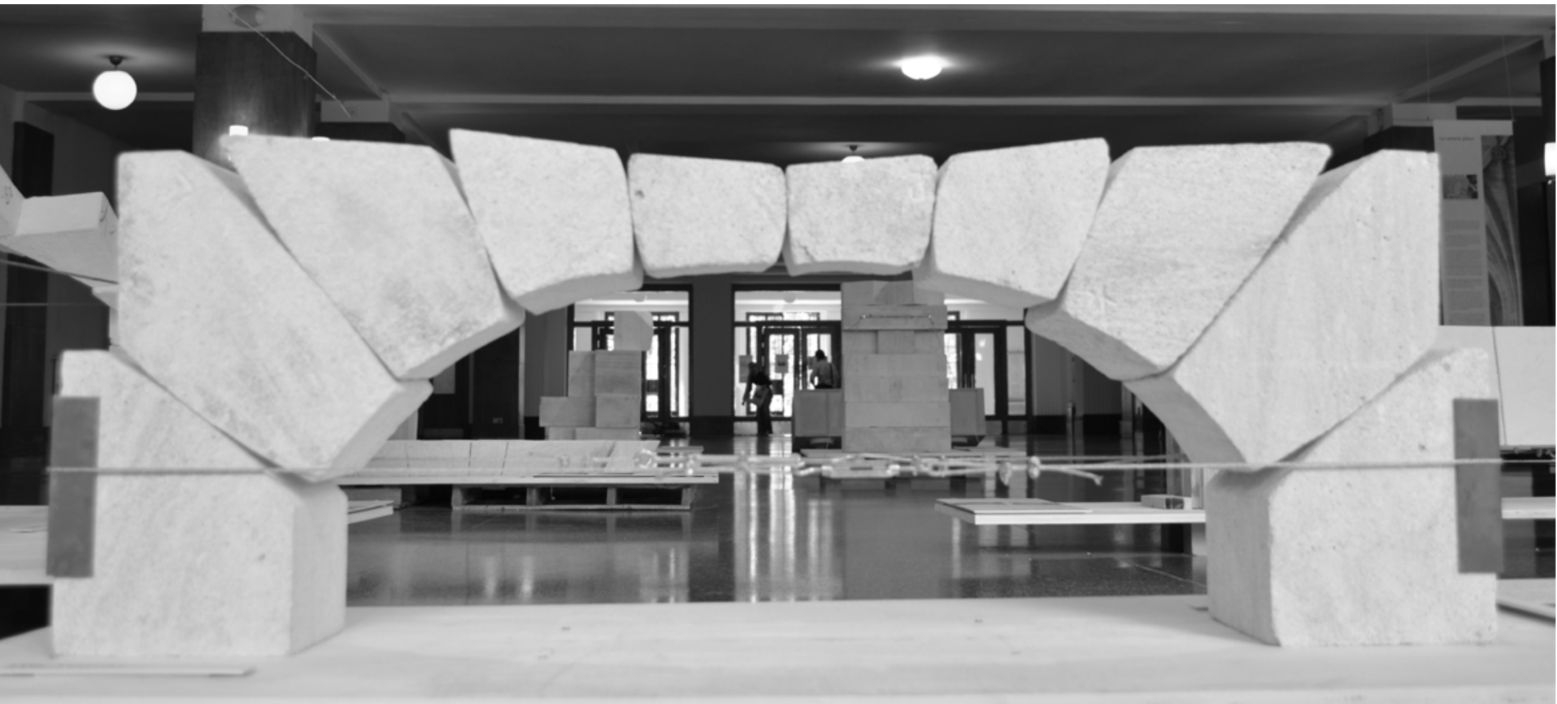
Arco móvil de lechos curvos (experimento del siglo XIX)
