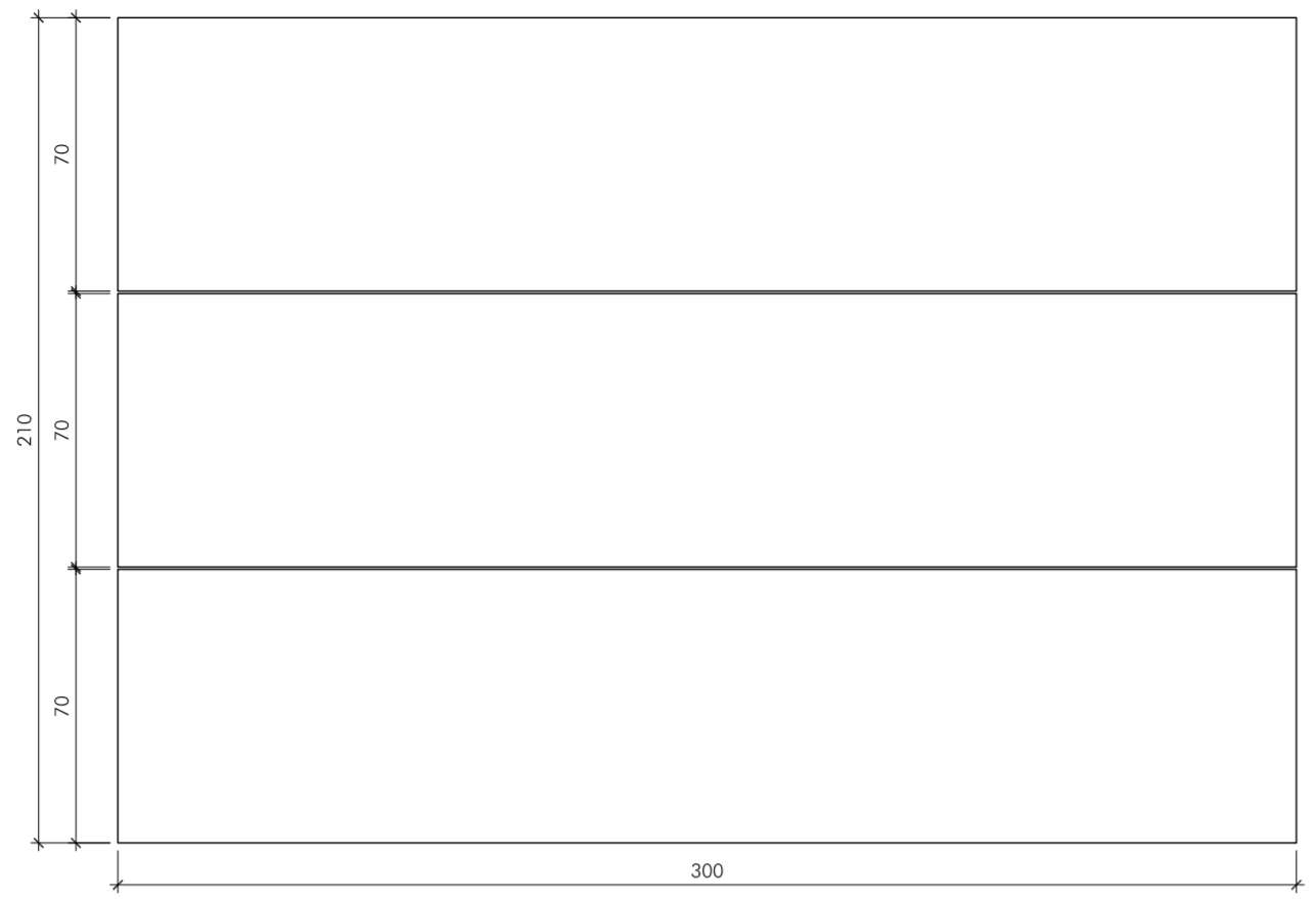
HOJAS DE MÁRMOL BLANCO MACAEL 300 x 70 cm ANCLADAS A BASTIDOR DE ACERO TUBULAR MEDIANTE ANCLAJES VISTOS DE ACERO INOXIDABLE
