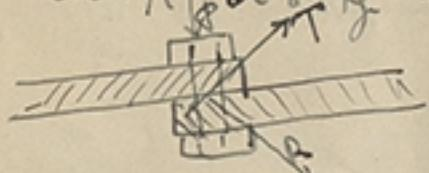
Se requiere de modo que no vayan girar los dos piezas. Hg la compresión, a la que se opone la tracción del cuerpo del perno. De parte ander ejige la reacción: tiene ser cortado la penetración del cuerpo del perno y separa la de la mitad que queda de la abra:
